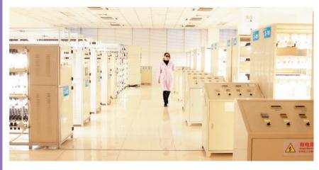
高温高湿交变循环通电、100°C到40°C的快速冷热冲击、IPX5的喷水、35℃/5%的NaCl溶液的喷雾、45°C的高温寿命燃点……横店集团得邦照明股份有限公司的照明产品样品在量产前必须在一个地方经历这"九九八十一难"。这个地方便是得邦照明检测中心。
